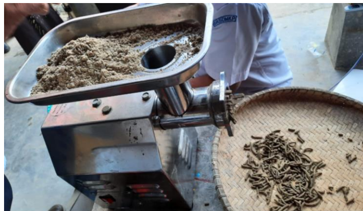
Gambar 9. Bahan pakan dicetak menggunakan mesin pencetak pakan
