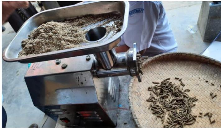
Gambar 9. Bahan pakan dicetak menggunakan mesin pencetak pakan
