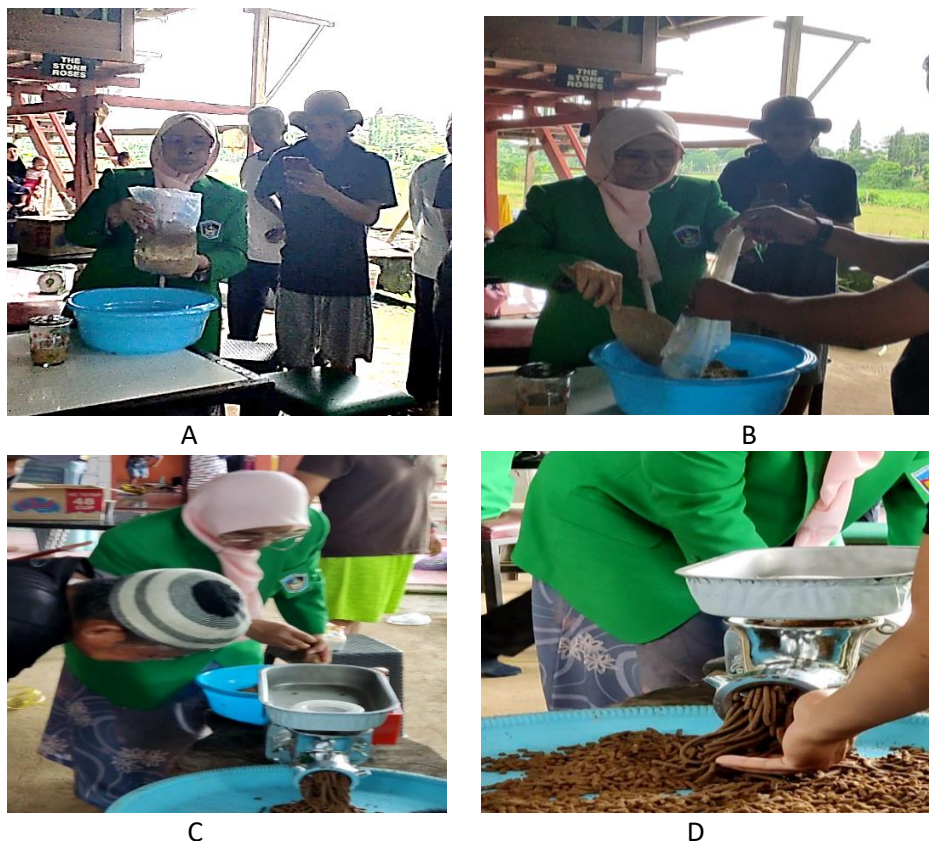
Gambar 7. a) Proses penyiapan bahan. b) Pencampuran semua bahan. c) Persiapan pencetakan pellet. d) Pencetakan Pellet.
