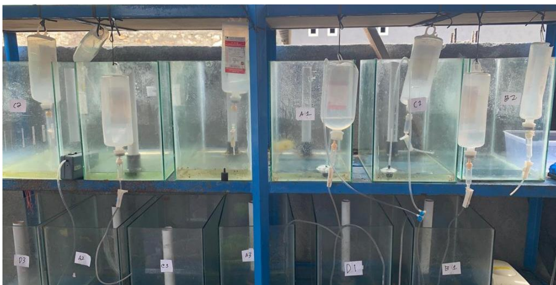
Gambar 2. Desain wadah pemeliharaan ikan dengan menggunakan botol infus Figure 2. Design of a fish rearing media using an infusion bottle
